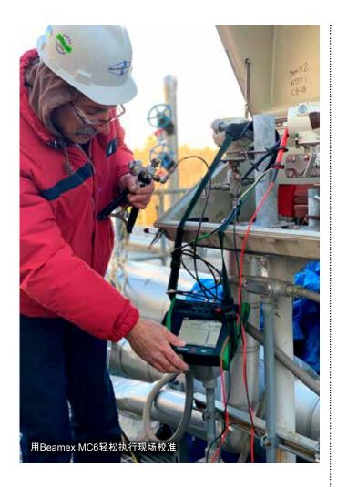
Bryan接着说: "标准化系统和流程非常奏效。最近,我们应邀到一座新电厂处理停机问题,这也是该电厂第一次停机。他们没有打开通往室外压力变送器的暖气管道,环境温度降至冰点以下,仪表底部支架被冻住,希望我们能给予紧急援助。因为是标准化作业,所以我们不必浪费时间去寻找合适的仪表校准量程或误差范围,只要校准还可继续使用的仪表,或替换完全不能再用的仪表即可。多亏这个系统,电厂两天内就重新开机运行。如果没有这个系统,电厂可能无法按时重启,造成每天数百万美元的损失。"
